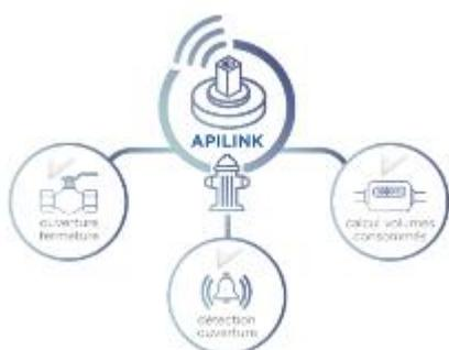
Ces dispositifs de surveillance connectés détectent l'ouverture et la fermeture des poteaux, et calculent les volumes consommés. Ils peuvent être déplacés ou installés à poste fixe sur les poteaux incendie les plus critiques.
