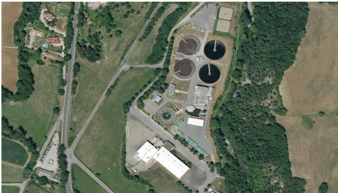
La station d'épuration construite en 1998 a été dimensionnée pour recueillir les effluents de 54 000 équivalents-habitants et traiter un débit moyen d'environ 11 000 m<sup>3</sup>/j.
